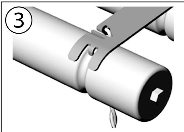
STEP 3 ベルトをローラーへ固定する
